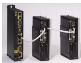
図17: ParkerのACR制御装置とAriesの駆動装置
